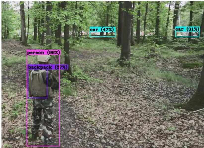
Image vue dur robot suiveur, détection et classification par apprentissage machine
